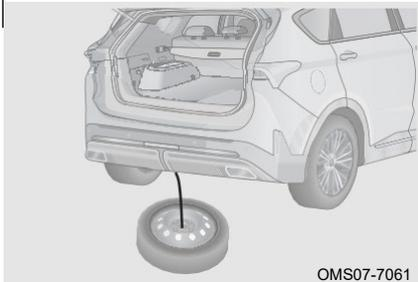
4. Выньте крюк устройства крепления запасного колеса и запасное колесо, когда запасное колесо будет опущено в самое нижнее положение.
