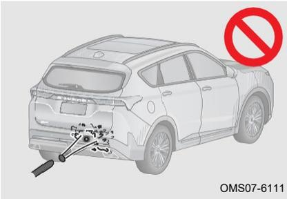
Поток воды под высоким давлением, такой как водяные пистолеты, или большая внешняя сила воздействия могут повредить радарные датчики. Не зажимайте и не ударяйте радарный датчик, иначе это может привести к ненормальной работе.
