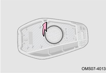
3. Извлеките аккумулятор из смарт-ключа с помощью плоской отвертки с заклеенным наконечником и установите новый аккумулятор;
