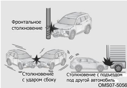
Подушка безопасности водителя и подушка безопасности переднего пассажира могут не сработать, если передняя часть автомобиля ударится о телеграфный столб, попадет под грузовик или попадет в наклонное боковое столкновение.
