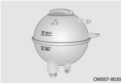
При холодном двигателе уровень охлаждающей жидкости должен находиться между отметками «MIN» и «MAX». Если уровень находится на отметке «MIN» или ниже нее, долейте охлаждающую жидкость и обратитесь на авторизованную станцию технического обслуживания для проверки и ремонта.
