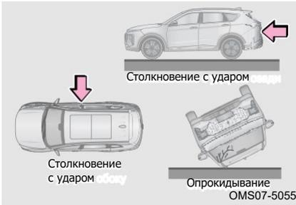
Подушка безопасности водителя и подушка безопасности переднего пассажира могут не сработать при боковом столкновении, при ударе сзади, переворачивании или переднем столкновении на низкой скорости.
