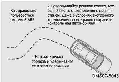
Антиблокировочная тормозная система (ABS) не работает при обычном торможении и немедленно включается только при экстренном торможении (педаль тормоза пульсирует с шумом, обеспечивая эффективность торможения и рулевого управления, если места достаточно, автомобиль также может объезжать препятствия). Никогда не отпускайте педаль тормоза в этом случае.
